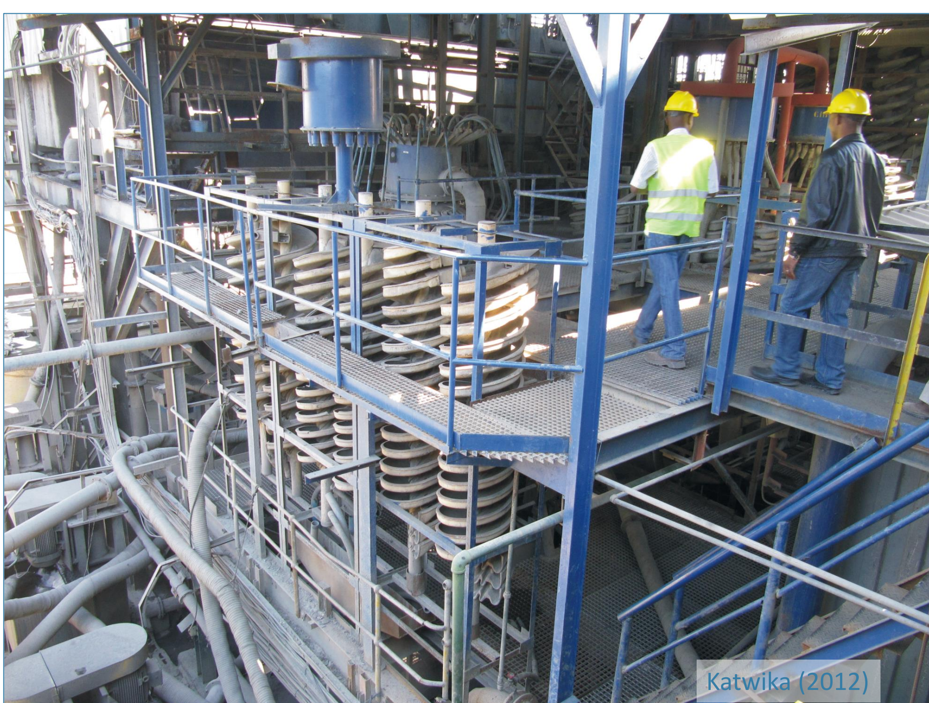
Verbeterde prestaties van de nieuwe Kipushi Concentrator door toepassing van centrifugale gravimetrische concentratie. Amélioration des performances du nouveau concentrateur de Kipushi par application de la concentration gravimétrique centrifuge.
