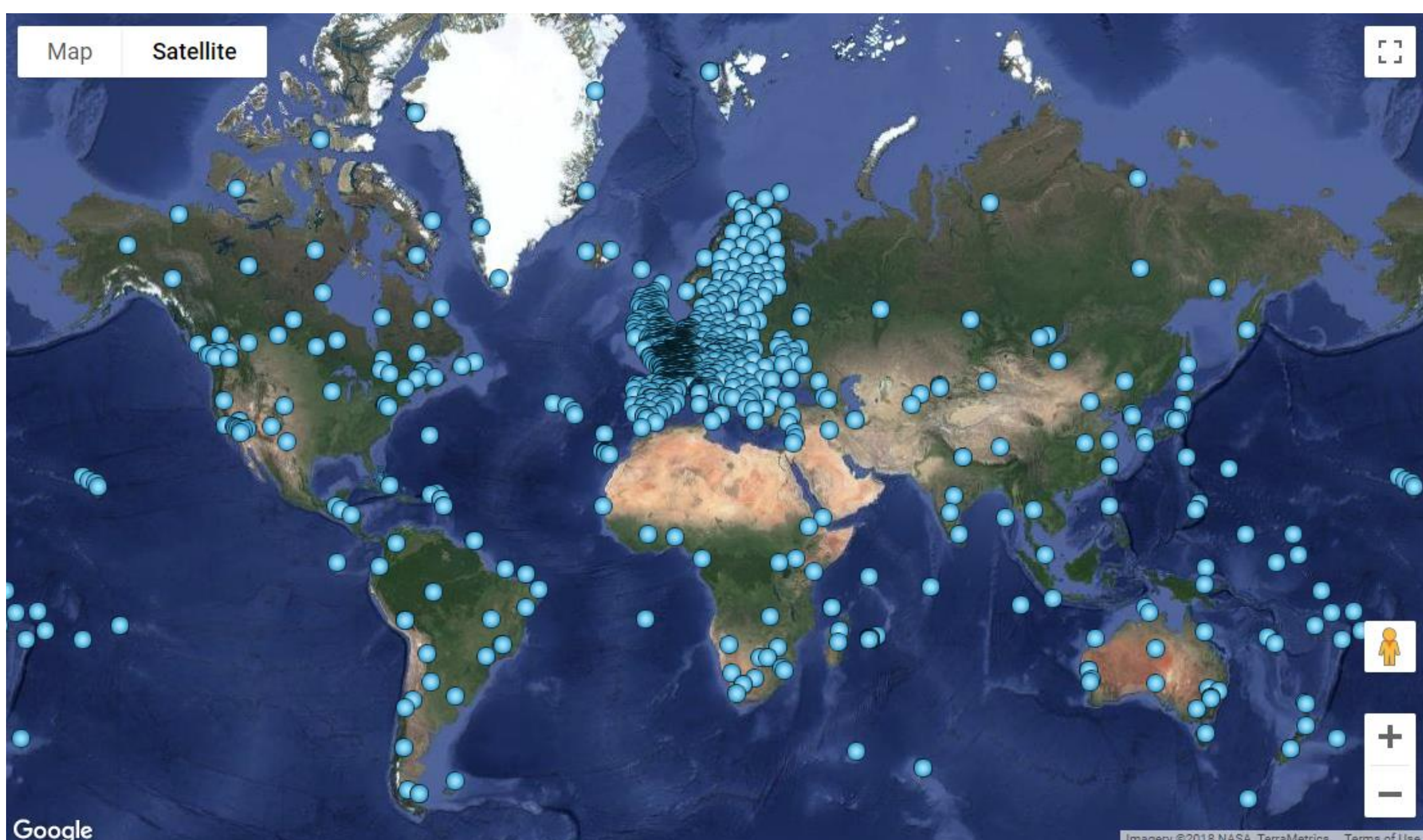
Stations GNSS permanentes: réseaux international IGS, européen EPN et nationaux (FR, BENELUX, UK) Permanente GNSS-stations: internationale IGS, Europese EPN en nationale netwerken (FR, BENELUX, UK)
